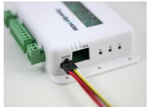
Bei der Verwendung von Zonenexpansionsplatinen werden die Sprinklerventile auf die gleiche Weise verdrahtet wie zuvor: ein Draht von jedem Ventil sollte zusammengeführt werden und zum COM-Anschluss des OSPi gehen; und der andere Draht von jedem Ventil geht zu einem individuellen Stationsterminal.
