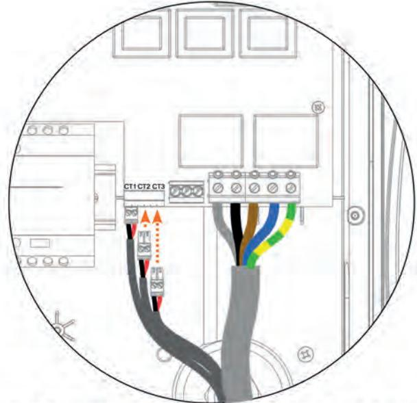
Für 3-Phasen-Installationen mit dem Einsatz von 1 oder mehreren externen/zusätzlichen CT's verwenden Sie bitte das obige Diagramm.
