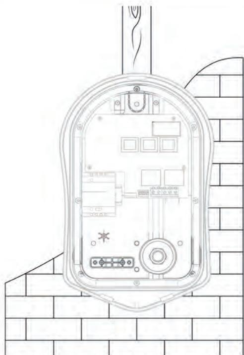
Markieren Sie die Montagelöcher mit Hilfe einer zappi-Schablone. Obere und 2 untere Löcher links/rechts für Ziegel verwenden. Bei Montage an einer Ständerwand oder einem Balken 2 vertikale Löcher verwenden.
