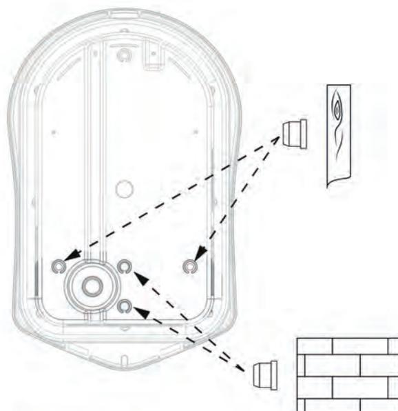
Um die Schutzart IP 65 zu gewährleisten, verschließen Sie alle nicht benötigten Kabeldurchführungen oder Bohrlöcher mit den mitgelieferten oder im Handel erhältlichen Stopfen.
