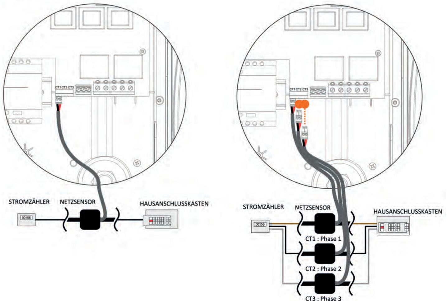
**1-phasig:** Der CT-Sensor muss auf der entsprechenden Leitung befestigt werden. Der Pfeil zeigt beim stromführenden Leiter Richtung Verbraucher bzw. Importrichtung. Beim Nullleiter jedoch in umgekehrte Richtung.
