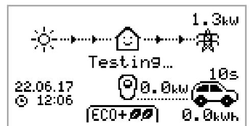
4. Der Boost startet entsprechend zu dem spätmöglichen Zeitpunkt, um die eingestellte Menge an Energie zu erreichen. Wenn der aktuelle Aufladezustand ausreichend ist, wird der Boost nicht erforderlich sein und wird gar nicht ausgeführt.
