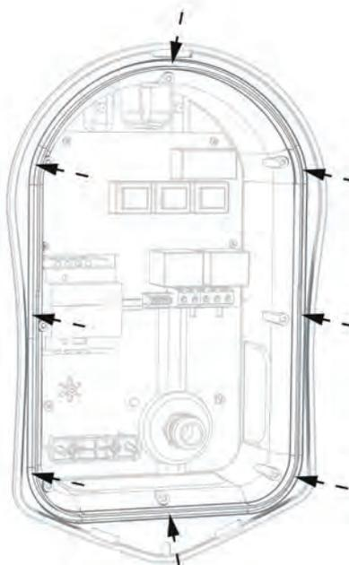
Stellen Sie sicher, dass der Dichtring vor dem Verschließen des Gehäuses korrekt in seiner Führungsnut liegt.
