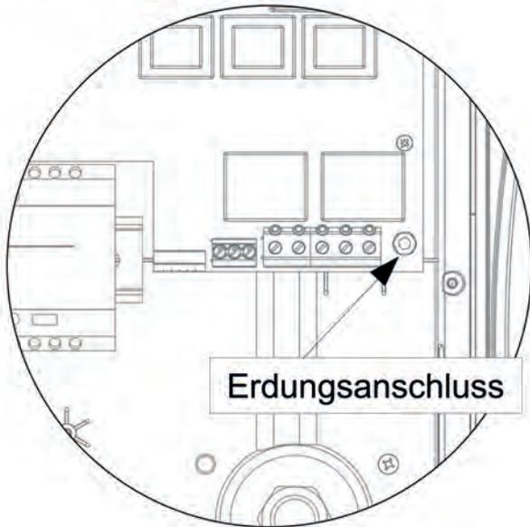
Führen Sie das Netzkabel durch die Verschraubung ein, falls noch nicht geschehen. Entfernen Sie die äußere Ummantelung. Achten Sie darauf, dass Sie mit der Kabellänge die Klemmenblöcke erreichen können. Lassen sie etwas Überlänge. Entfernen Sie von allen farbigen Kabel ca. 10 mm der Isolierung. Auch von den Kabeln der Stromwandler (CTs). Für die Durchführungen empfehlen wir spezielle Versionen, die mehrere Kabel aufnehmen können und IP65 beibehalten.
