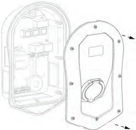
Drehen Sie vorsichtig alle 8 Schrauben aus dem Gehäuse heraus und heben Sie diese gut auf.
