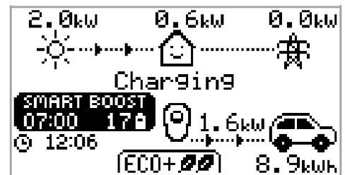
3. zappi testet dann für einige Sekunden das EV, um die maximale Aufladerate zu bestimmen.
