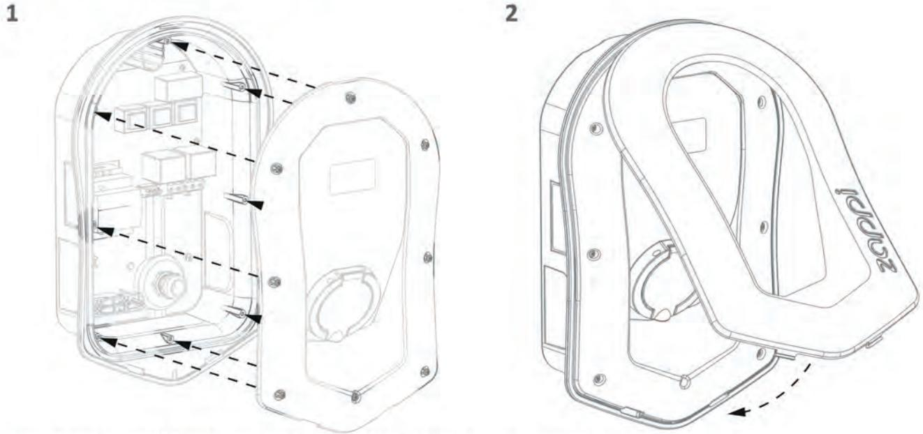
Zum Verschließen die Abdeckung gem. Abbildung aufsetzen und mit den 8 Schrauben befestigen. Auf den korrekten Sitz des Dichtungsring achten. Anzugsmoment der Schrauben **1,2 Nm**.
