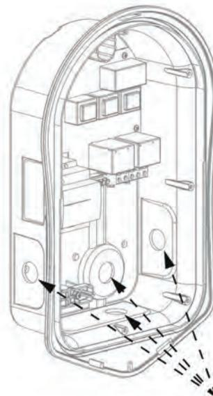
Für die Stromversorgung haben Sie 4 Kabeleinführungen zur Verfügung. Überlegen Sie sorgfältig, welche davon gem. obiger Abbildung für Sie baulich am günstigsten ist. Sie benötigen eine Kabelverschraubung nach IP 65 oder höher. Bohren Sie die ausgewählte Kabeleinführung vorsichtig auf und montieren Sie eine der Kabelverschraubungen.
