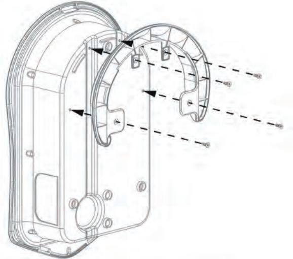
Wenn Sie ein kabelgebundenes zappi installieren, muss das Kabelwandschutz-Formteil mittels der 4 mitgelieferten Schrauben mit dem Gehäuse verschraubt werden. Wenn Sie die kabellose Version haben, gehen Sie weiter zum nächsten Schritt.
