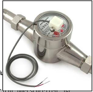
Es können auch Durchflusssensoren mit 3 Drähten verwendet werden, die 5 V benötigen. Verbinden Sie den Erdungskabel (in der Regel schwarz) an **GND**, das 5-V-Kabel (in der Regel rot) an **+5 V (oder VIN)** und das Datenkabel (gelb) an **SN1**. Aufgrund von Softwarebeschränkungen sollte die Signalfrequenz des Durchflusssensors 50 Hz nicht überschreiten, da höhere Frequenzen zu ungenauen Messwerten führen können.
